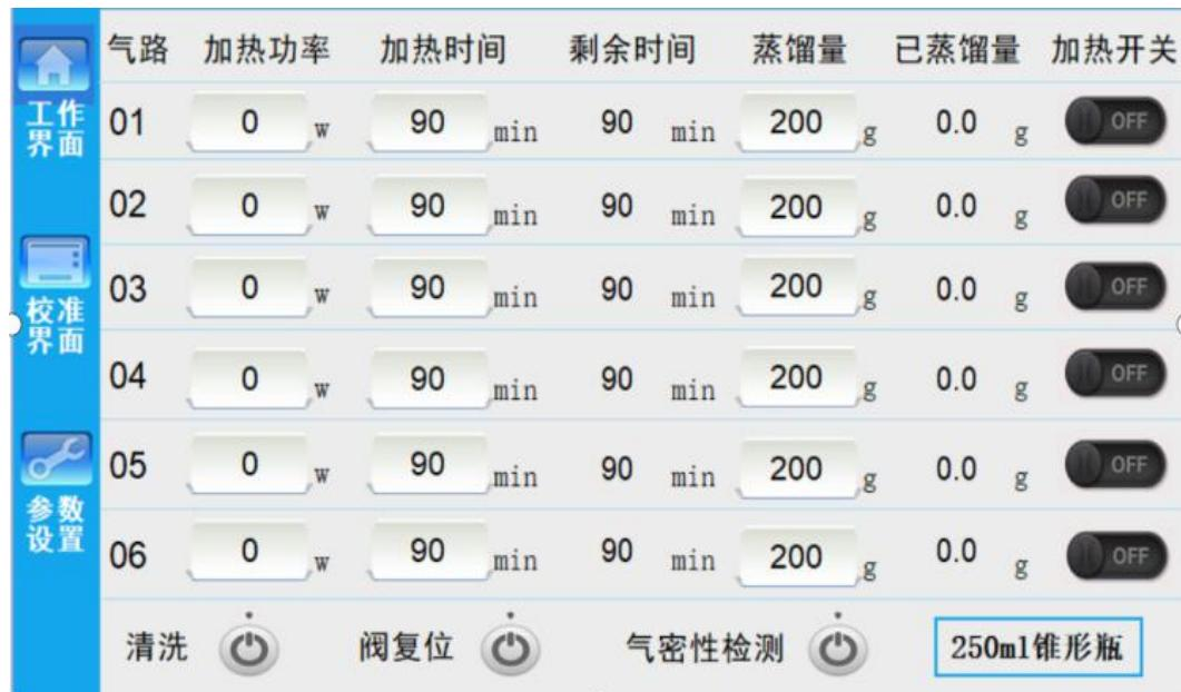
点击“清洗”按钮，弹出“自动清洗气路选择”界面，选择相应需要清洗的通道，然后点击“开始清洗”按钮，则仪器依次自动将放置在称重托盘上的清水，抽到
