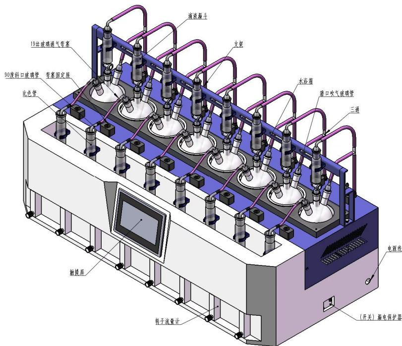
(2) 向分液漏斗内加入 15ml 1+1 的磷酸溶液，旋开活塞，待磷酸溶液流入反应瓶中 10ml 时（剩余 5ml 作为液封），迅速关闭活塞。再次开启气源，调节流量计流速 300ml/min，对待测样品在恒温水浴条件下连续吹气 30min。
