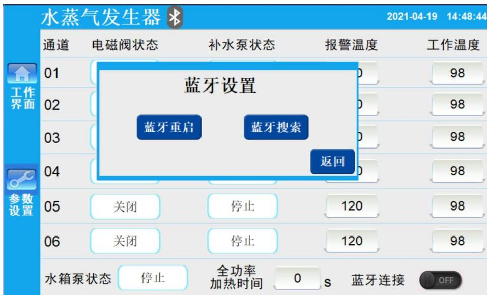
首先使蒸馏仪处于开机状态，先将蒸馏仪中的蓝牙开关打开。然后点击蒸气发生器参数设置界面右下角的蓝牙连接按钮，在弹出的蓝牙设置界面中点击蓝牙搜索按钮，水蒸气发生器会和蒸馏仪自动进行蓝牙连接。连接成功后，屏幕上的灰色蓝牙标志会变为蓝色。
