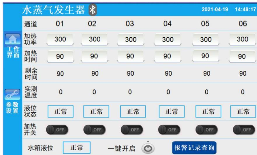
加热开关：控制单路加热的启停。显示灰色按钮“OFF”表示加热未开启，显示绿色按钮“ON”表示加热开启，启停需手动点击触控按钮控制。
